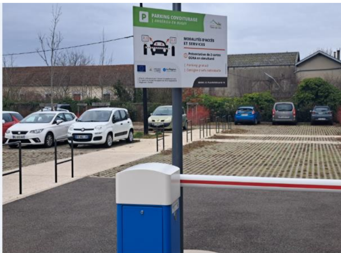
Figure 4 : parking covoiturage avec revêtement drainant (source : rapporteurs)
