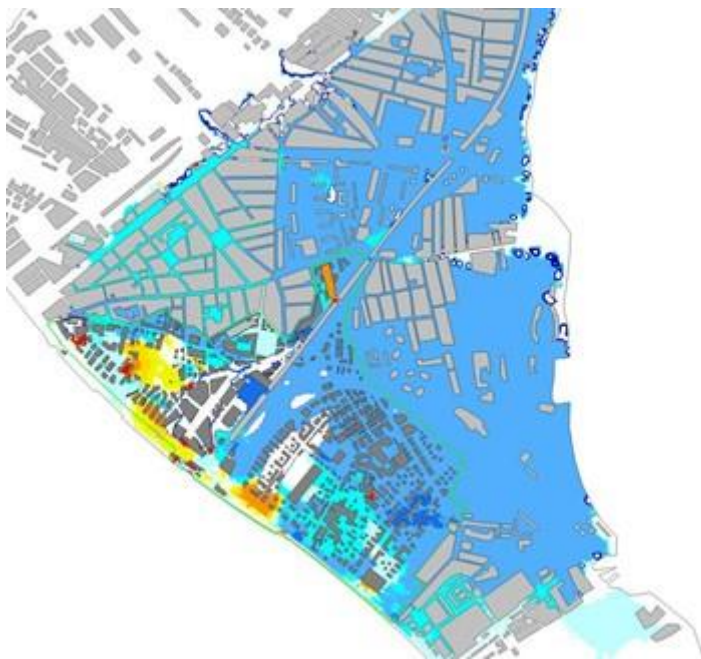
Figure 7 : cartographie des niveaux d'eau après mesures définitives – couleurs chaudes : aggravation de 1 cm à 50 cm , couleurs froides : amélioration des niveaux d'eau de 1 cm à 50 cm, blanc : aucune modification et gris : mise hors des plus hautes eaux (source : dossier).
