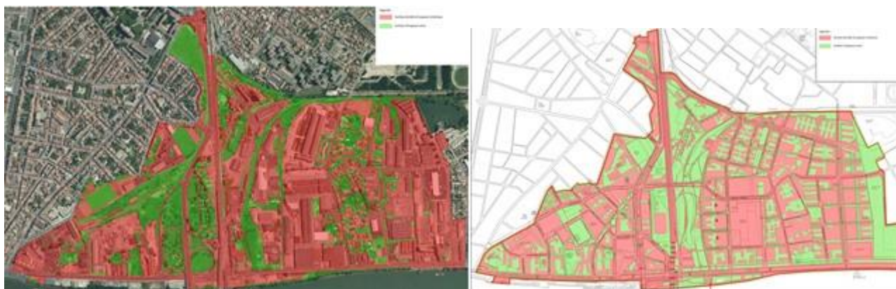
Figure 5 : imperméabilisation en rouge et désimperméabilisation en vert avant-projet (à gauche) et après projet (à droite) – (source : dossier).
