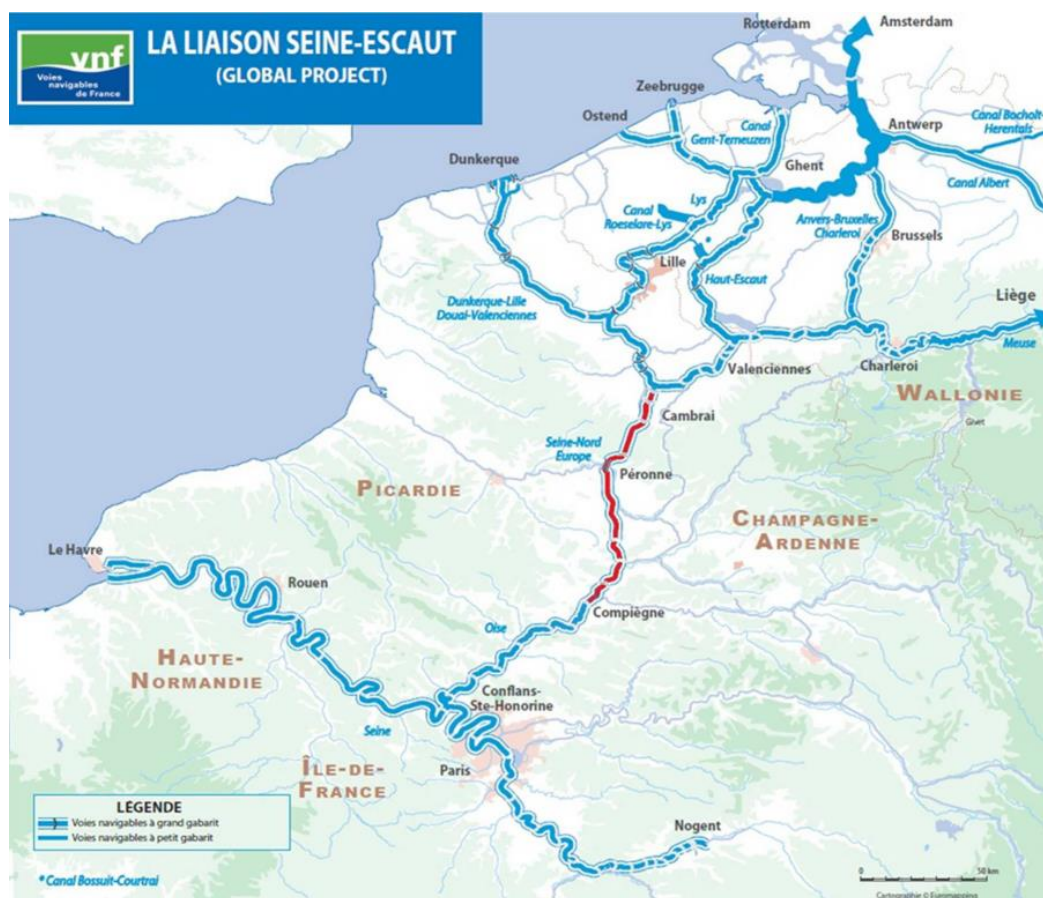
Figure 1 : Projet de canal Seine–Nord Europe au sein du réseau fluvial Seine–Escaut (source dossier)
