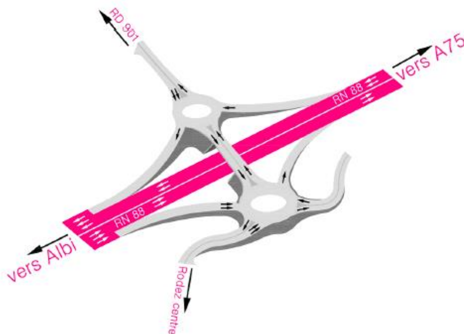
Figure 5 : Aménagement du giratoire des Moutiers (source : dossier)
