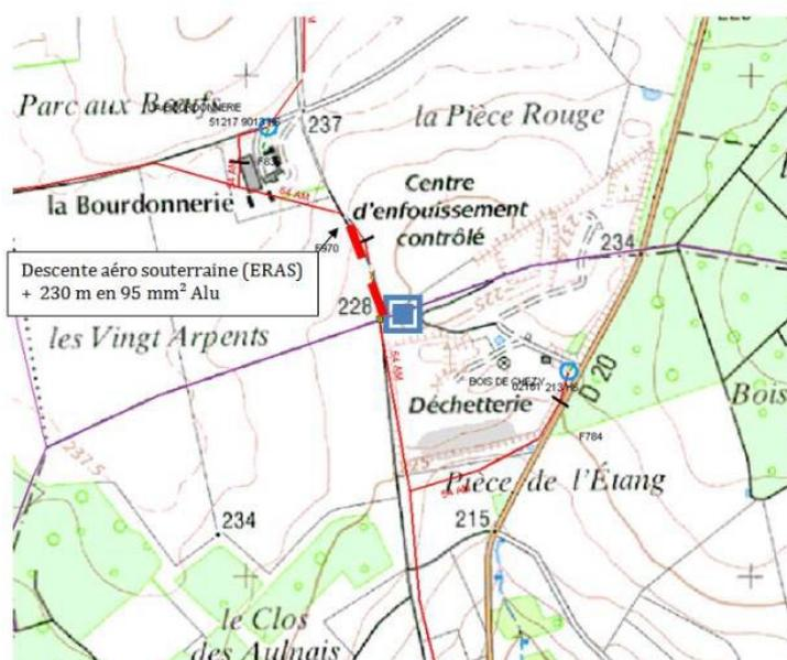
Figure 4 : Schéma de raccordement au réseau public de distribution d'électricité envisagé (source : dossier)/ Le poste de livraison est figuré en bleu, et le raccordement à créer en tirets rouges.
