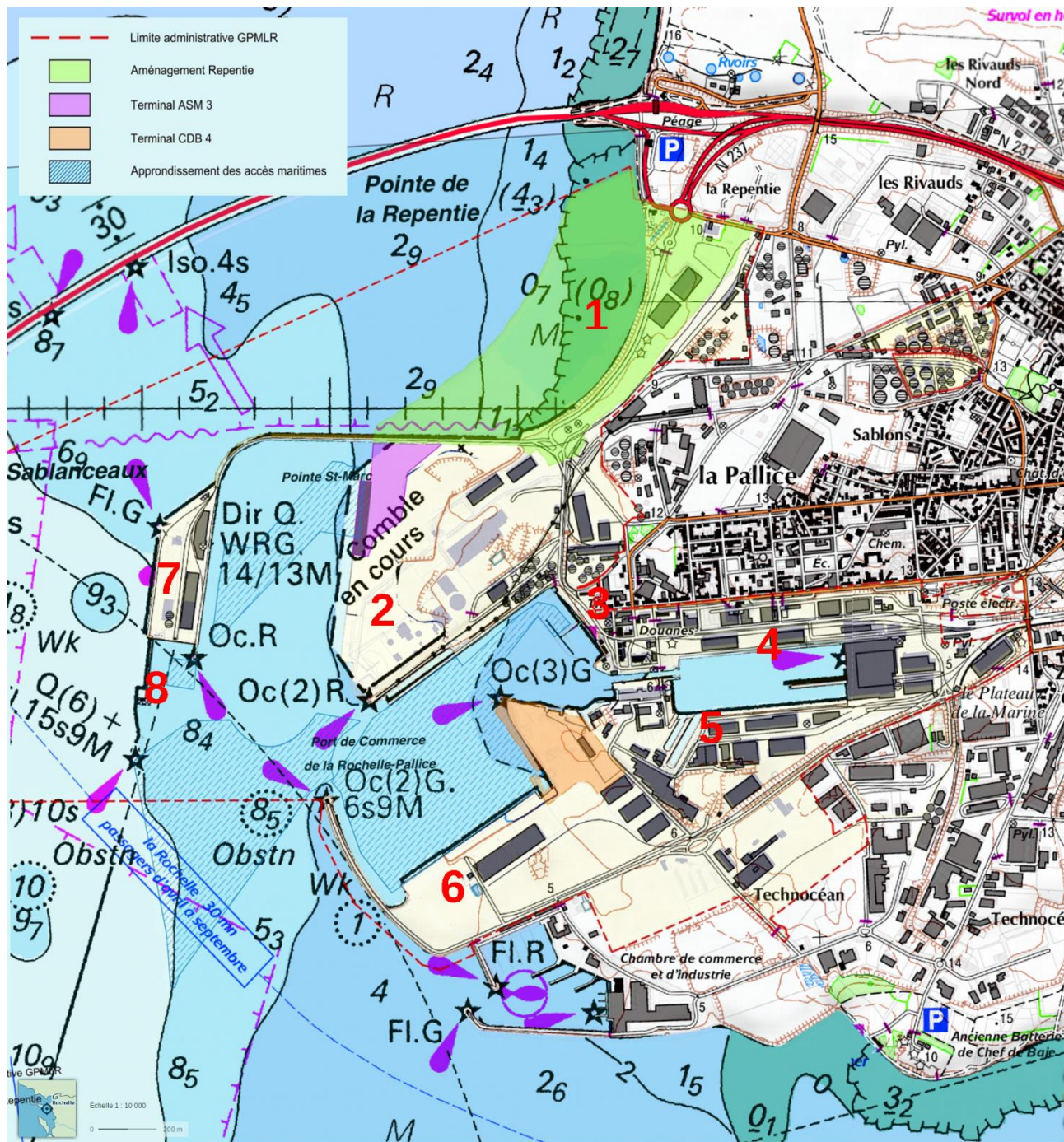
Figure 2 : Carte du site du port de La Rochelle à l'échelle 1/10 000. Les nombres figurés en rouge correspondent aux différents terminaux (1 : La Repentie ; 2 : anse Saint-Marc ; 3 : Port de service ; 4 : bassin à flot ; 5 : pôle de réparation et de construction navale ; 6 : Chef de Baie ; 7 : môle d'escale ; 8 : terminal pétrolier. Les zones de travaux sont figurées en couleur selon le cartouche en haut à gauche. Sources IGN, Shom et dossier.
