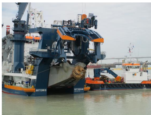
Figure 7 : Dérocteuse hydraulique avec vrille foreuse aspiratrice. Source dossier.
