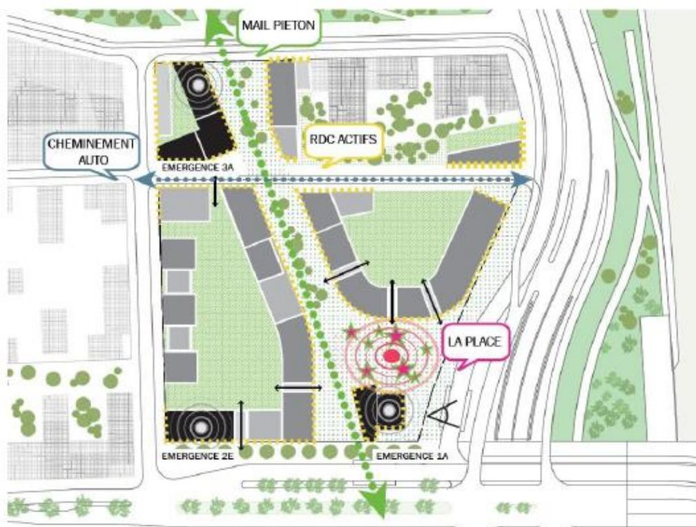
Figure 4 : Plan du projet immobilier Quai de Brienne – (source : dossier) éléments structurants dont, de noir à gris clair selon leur hauteur, les bâtiments qui seront construits (les parties quadrillées en gris sont des bâtiments d'un autre projet, le plus à l'est est déjà construit ; les points et surfaces en vert sont en partie ou totalement végétalisés)
