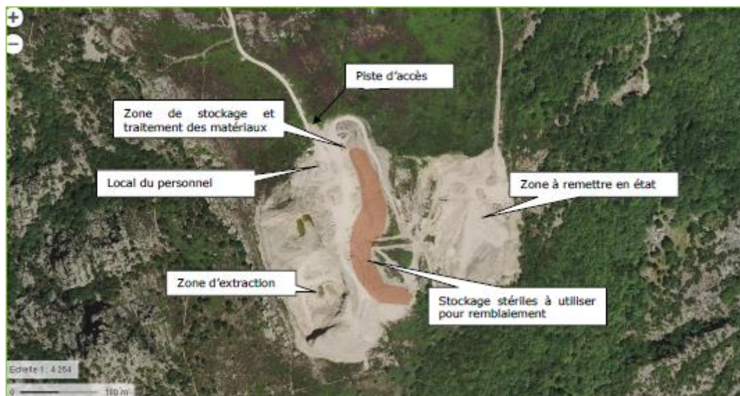
Figure 2 : Photo aérienne du site de la carrière et localisation des différentes zones (Source : dossier)
