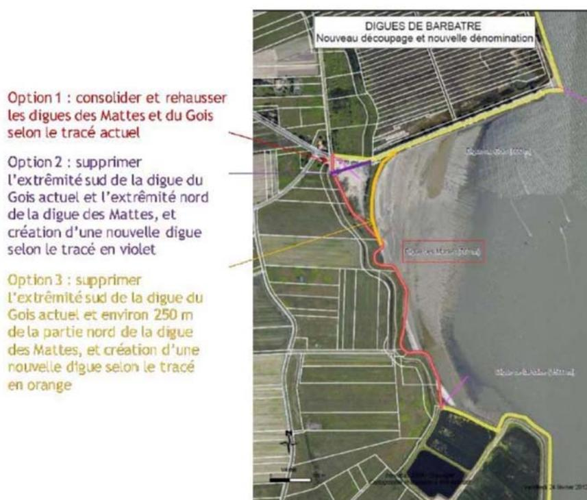
Figure 5 : présentation des différentes options envisagées pour la rehausse de la jonction entre la digue du Gois et la digue des Mattes. (Source dossier)
