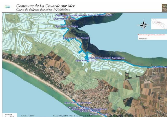
Figure 3 : Système de digues actuelles à l'ouest de La Couarde. En vert, les surfaces inondées lors de Xynthia. Source : PAPI
