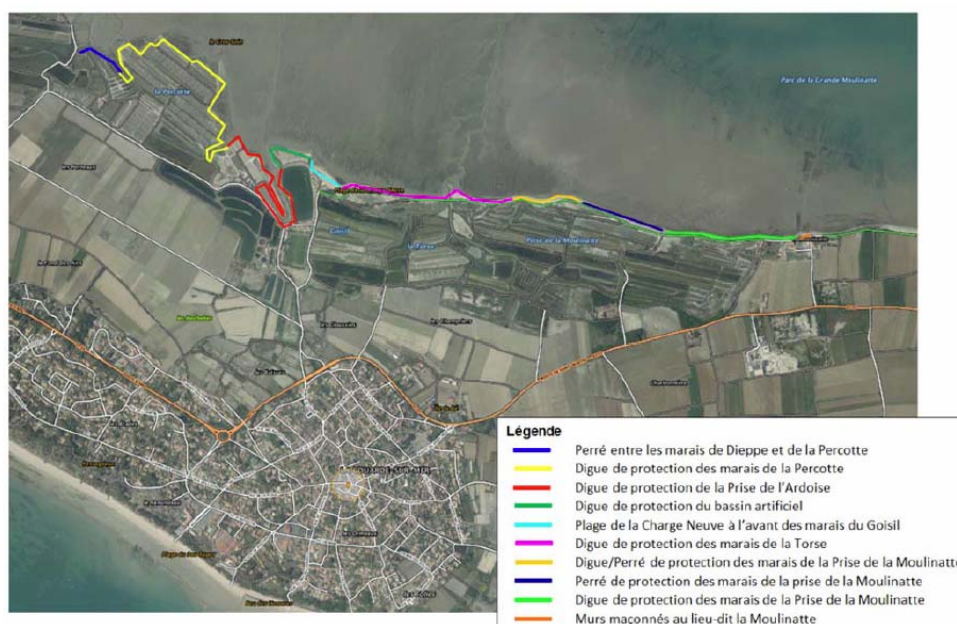
Figure 2 : Aménagements de la digue de La Couarde. Source dossier
