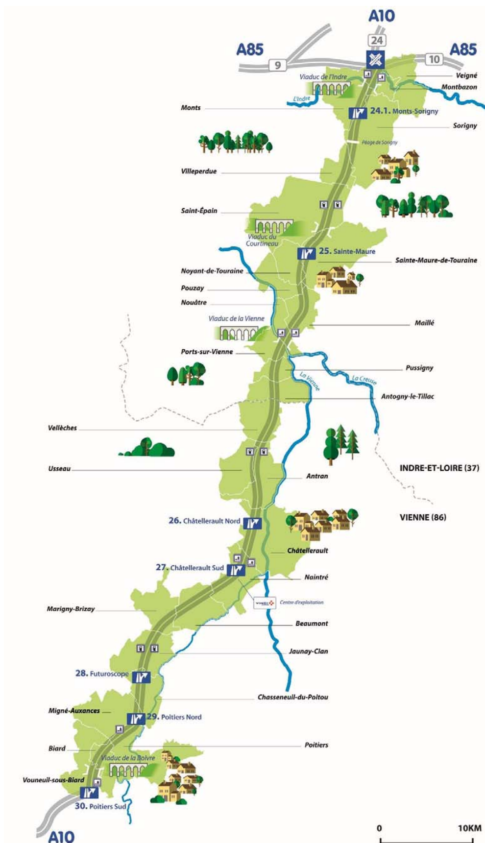
Figure 1 : Tracé schématique du tronçon d'autoroute objet de l'élargissement de deux fois deux voies à deux fois trois voies (Source : dossier)
