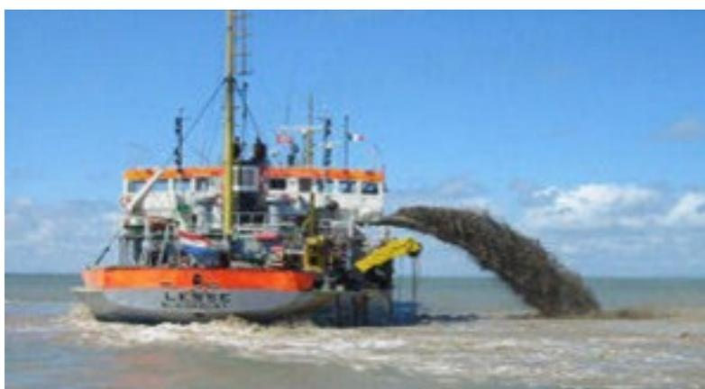
Figure 4 : refoulement latéral du mélange eau + sédiments par la DAM (source : CCI de Guyane)
