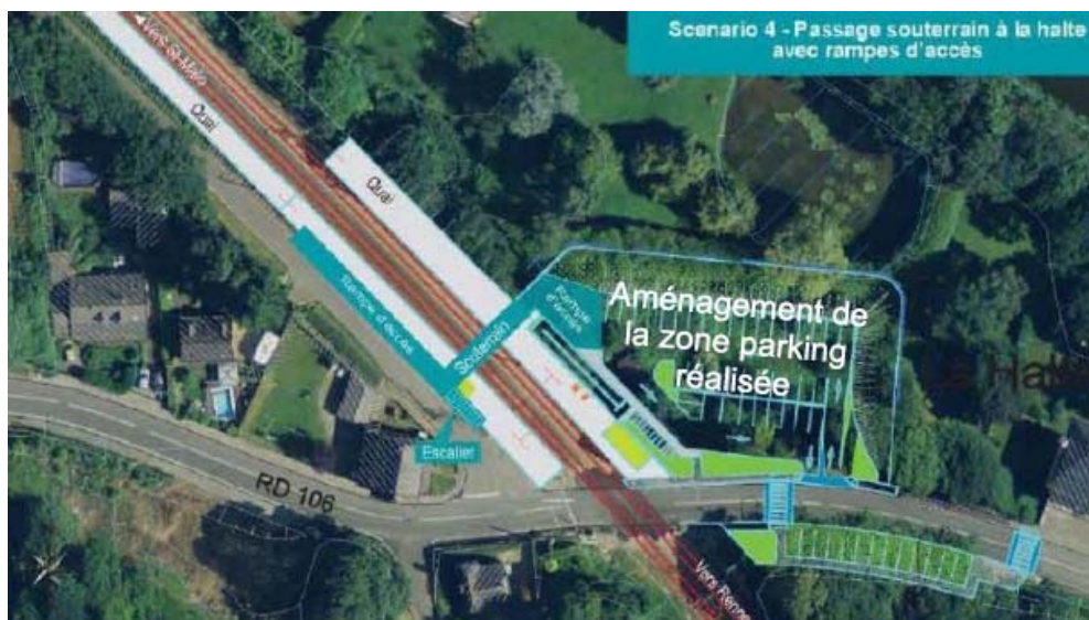
Figure 3 : franchissement pour les piétons et cyclistes (source : volume 1 pièce C du dossier)
