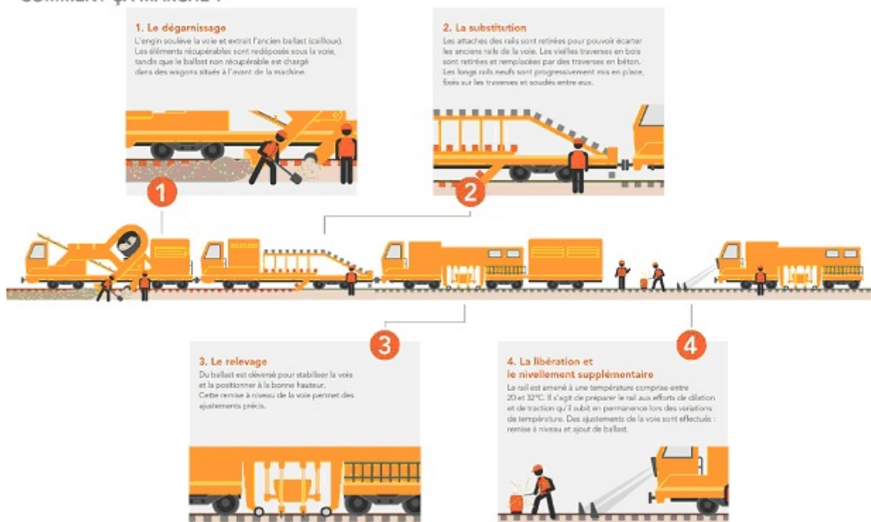
Figure 2 : le fonctionnement d'une « suite rapide 6 ». Source : dossier du maître d'ouvrage.
