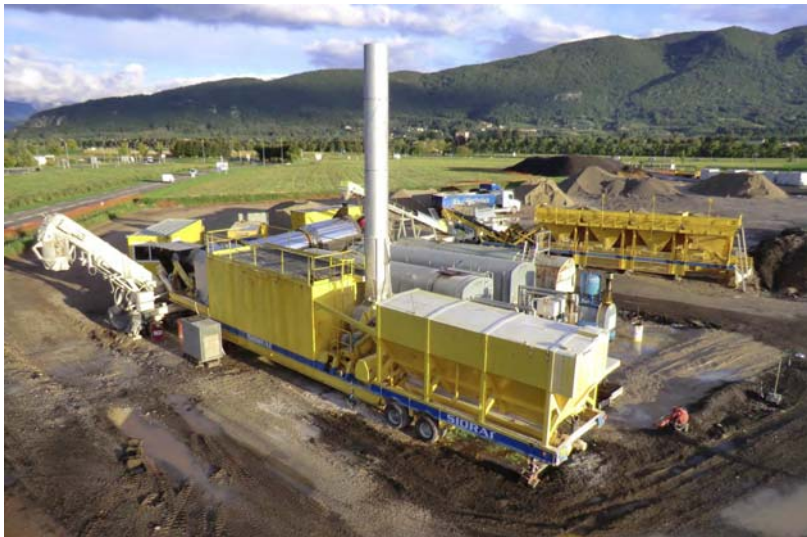
Figure 2 : Centrale d'enrobage TSM 19 MFMC de marque Argumat (source : étude d'impact).
