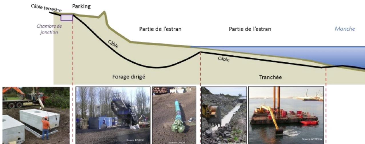
Figure 4 : coupe de principe de la solution technique d'atterrage (Source : Artélia, 2015)
