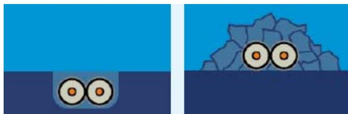
Figure 4 : coupe schématique d'un ensouillage (à gauche) et d'une protection externe (à droite) (source : étude d'impact)
