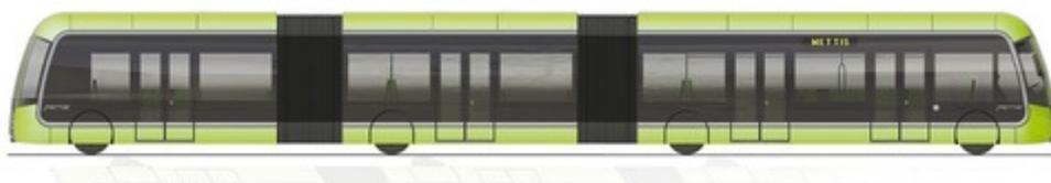
Figure 3 : Modèle de véhicule articulé T ZEN de 24 m (140 places)
