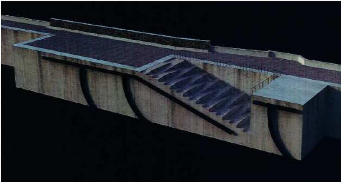
Figure 4 : Quai à paliers encadré par deux quais-poids (solution proposée à Molène, source : dossier remis à l'Ae)
