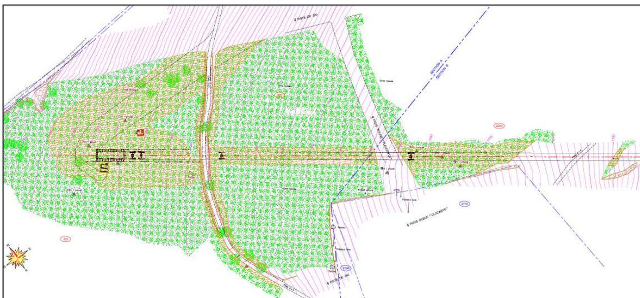
Figure 5 : Défrichements nécessaires au projet, partie aval (la zone à défricher est en hachures bistre).
