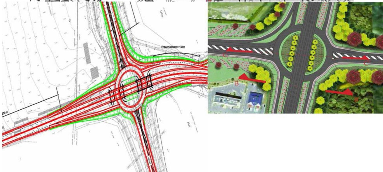
Figure 7 : Inversion de la dénivellation RD 1016 - RD 201 (en rouge sur l'image de gauche : projet). Le giratoire sera de plus petite taille et situé en bas au niveau de la RD 201 actuelle, alors que le giratoire actuel est en haut au niveau de la RD 1016 et de plus grande taille. Source : dossier DUP
