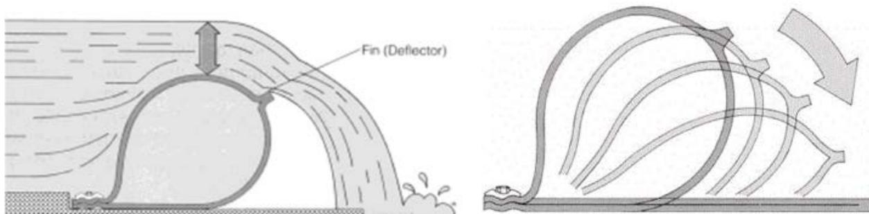
Figure 3 : Principe de fonctionnement d'un barrage gonflable à l'eau (source : étude d'impact)
