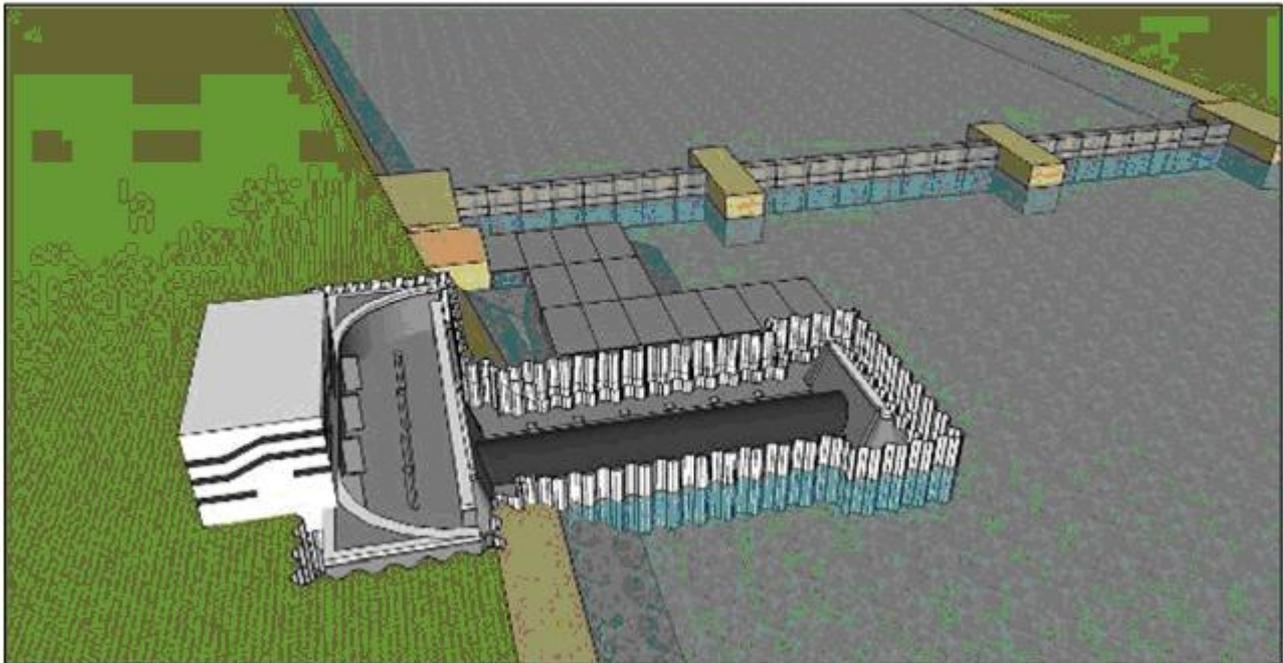
Figure 4 : Exemple d'une phase de chantier où la section d'écoulement de la Meuse est partiellement entravée par un batardeau.
