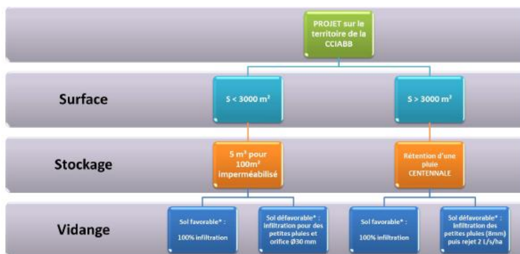
Figure 6 : dispositif de gestion des eaux pluviales suivant la superficie et la capacité d'infiltration. Source : dossier.
