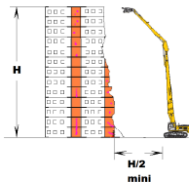
Figure 4 : schéma de référence type de l'emploi de la méthode dite par « émiettement » (source : dossier)
