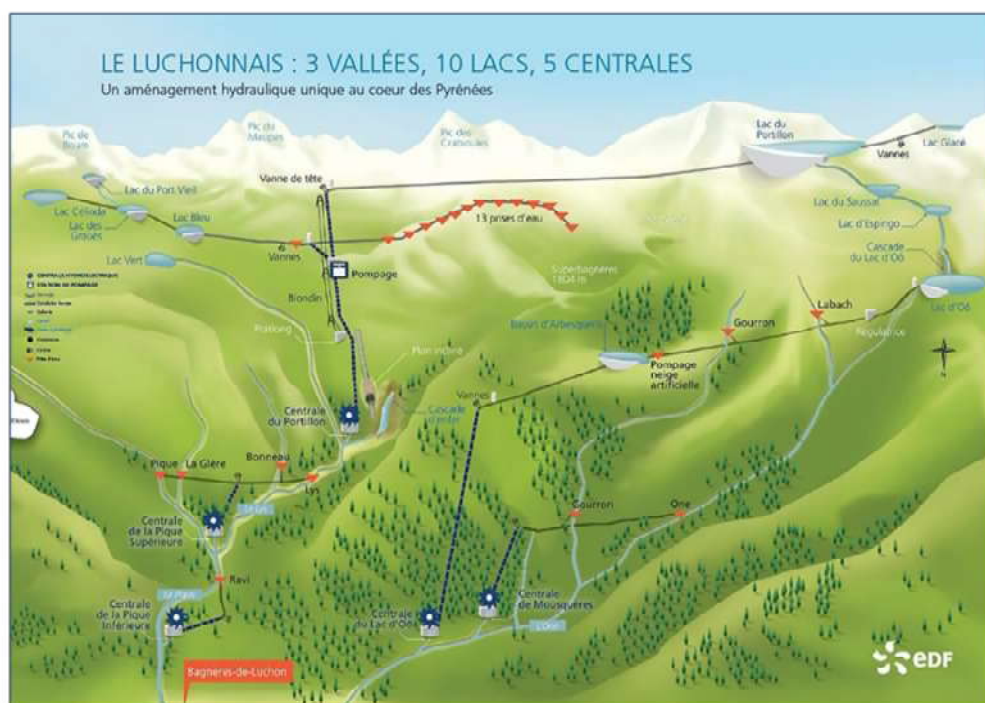
11 - Représentation schématique de l'équipement hydroélectrique - Source EDF
