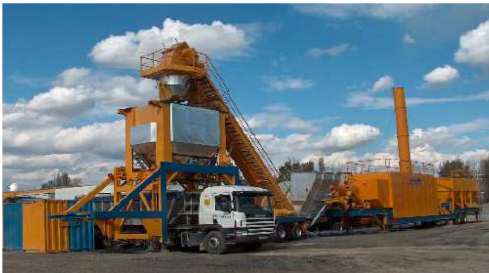
Figure 2 : photo d'une centrale d'enrobage du type utilisé pour le projet (Source illustration page 48 de l'étude d'impact)
