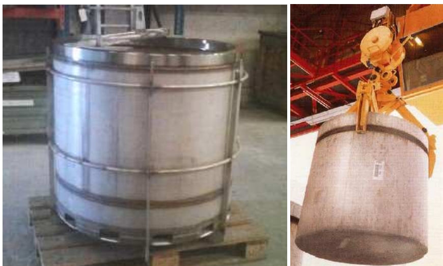
Panier métallique accueillant les déchets bloqués (à gauche) – Déplacement d'un colis C1PG (à droite) (source : étude d'impact)
