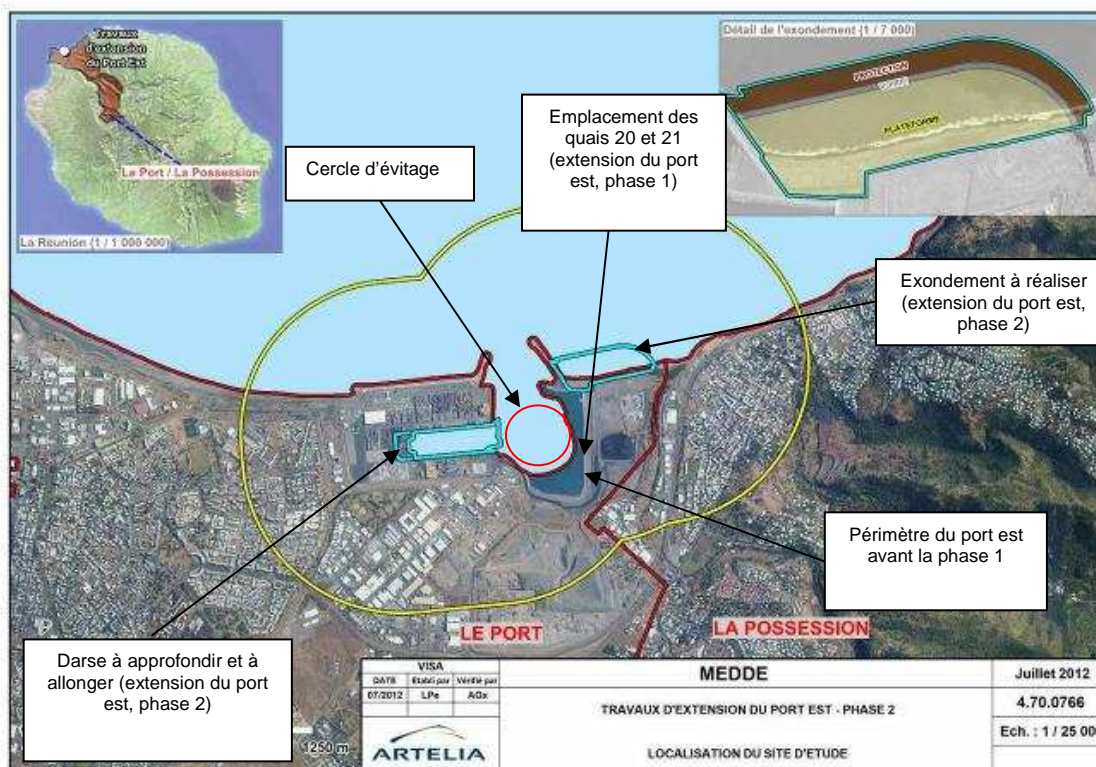
Figure 1: Le port est avant la phase 1 (localisation, plan de situation, périmètre d'étude). Source : notice explicative.
