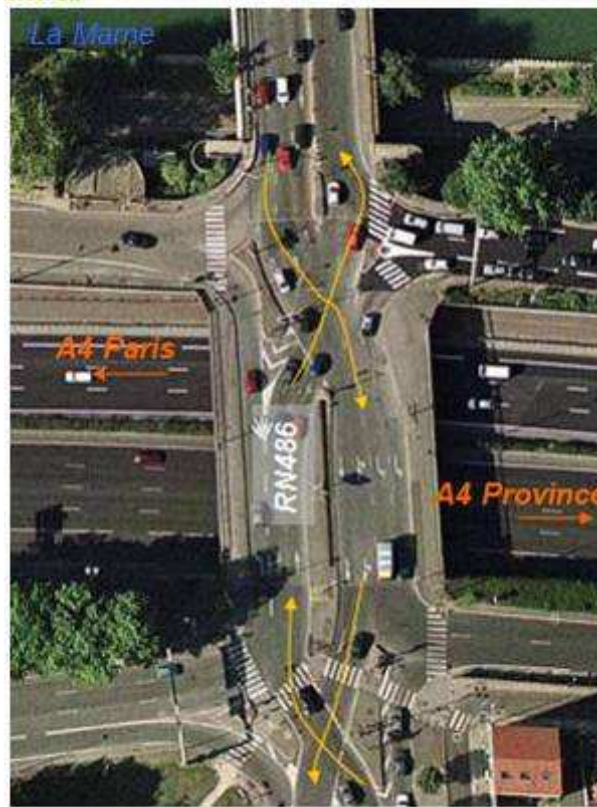
Figure 2 : Principe de fonctionnement de l'échangeur A4/RN486
